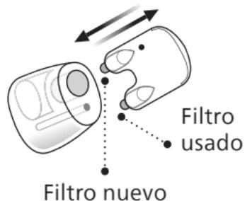
Utilice la otra punta para insertar el filtro anticerumen nuevo. Extraiga la herramienta y tírela.
