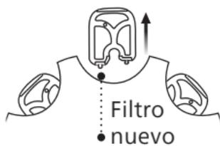
Extraiga la herramienta de la carcasa. La herramienta tiene dos puntas: una vacía para extraer y otra con el filtro anticerumen nuevo.
