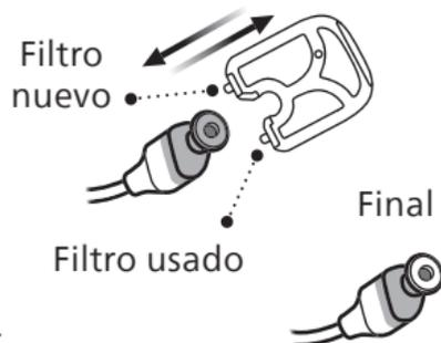
Utilice la otra punta para insertar el filtro anticerumen nuevo. Extraiga la herramienta y tírela.
