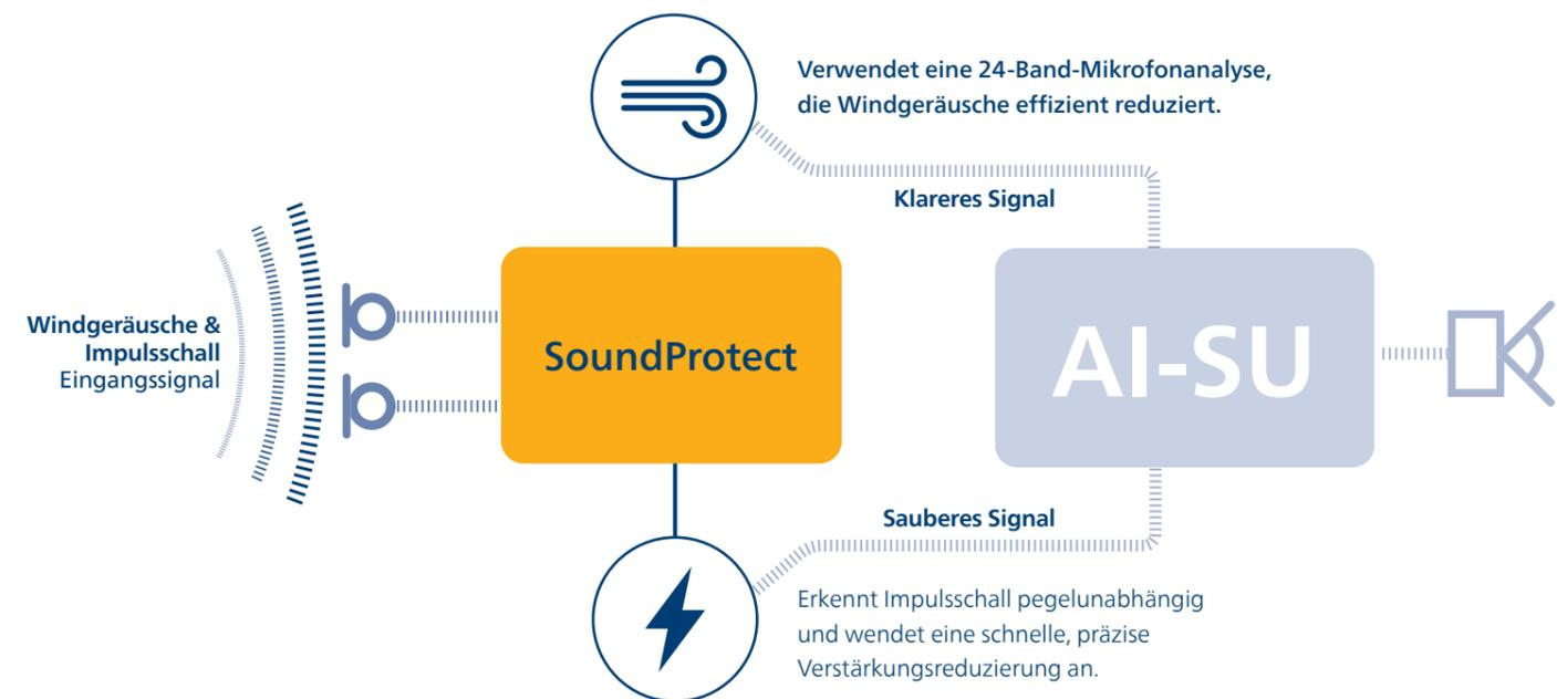
Abbildung 1: SoundProtect wurde entwickelt, um AI-SU mit einem sauberen Signal zu versorgen.
