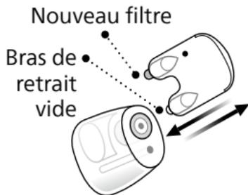
Insérez le bras de retrait vide dans le pare cérumen de l'embout et retirez-le.
