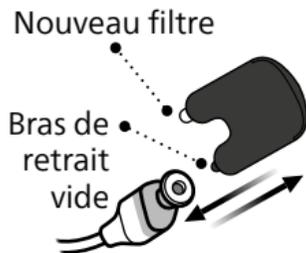
Insérez le bras de retrait vide dans le pare cérumen de l'écouteur et retirez-le.
