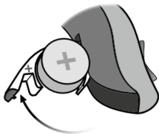
Ouvrez complètement le logement de pile et retirez la pile.
