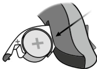
Insérez la nouvelle pile dans le logement de pile. Insérez-la depuis le dessus, PAS depuis le côté.
