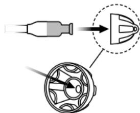
Insérez l'écouteur exactement au milieu du dôme afin de bien le mettre en place.
