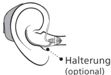
Schieben Sie das Ohrstück vorsichtig in den Gehörgang, bis das Kabel des Hörers eng am Kopf anliegt.
