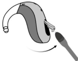
Drücken Sie das Werkzeug in die Öffnung, und ziehen Sie es wieder heraus, um die Tasterabdeckung zu öffnen. Halten Sie dabei das Multifunktionswerkzeug wie dargestellt, um Schäden zu vermeiden.
