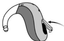
Drücken Sie den Taster wieder in Ausgangsposition zurück. Sie hören ein Klicken, wenn der Taster korrekt geschlossen wurde.
