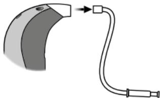
Ziehen Sie den Dünnschlauch aus dem Hörsystem, und entfernen Sie das Ohrstück.
