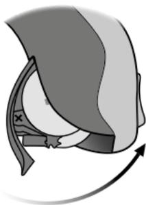
Schließen Sie das Batteriefach.
