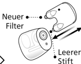
Drücken Sie den leeren Stift in den Cerumenschutz im Ohrstück. Ziehen Sie den alten Cerumenschutz heraus.
