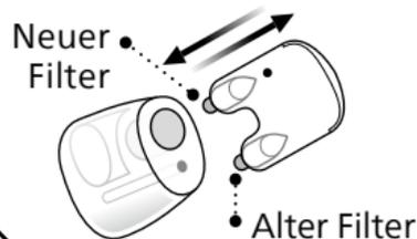
Setzen Sie den neuen Cerumenschutz mit dem anderen Stift ein. Entfernen Sie das Werkzeug, und entsorgen Sie es.
