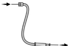
Führen Sie das Reinigungswerkzeug durch den gesamten Dünnschlauch.
