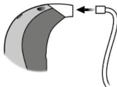
Verbinden Sie anschließend den Dünnschlauch wieder mit dem Hörsystem.
