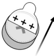
Ziehen Sie die Schutzfolie von der +-Seite der neuen Batterie ab.
