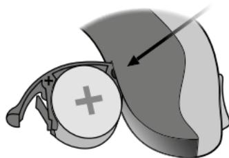
Setzen Sie die neue Batterie in das Batteriefach ein. Legen Sie die Batterie VON OBEN ein, NICHT von der Seite.
