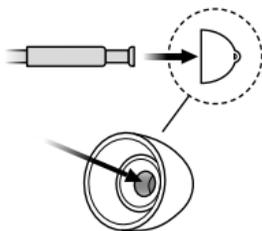
Setzen Sie den Dünnschlauch exakt in die Mitte des Ohrstücks, damit er fest sitzt.
