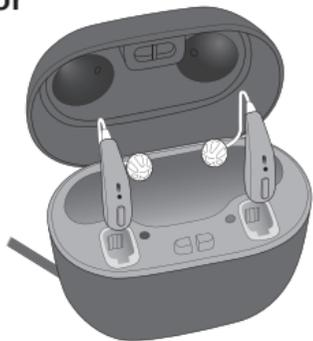
Coloque los audífonos en los puertos de carga como se muestra en la imagen y cierre la tapa. Asegúrese de que sus audífonos coinciden con los indicadores de color izquierdo y derecho en los puertos de carga del cargador.
