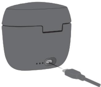
Inserte el otro extremo del cable USB en la parte trasera del cargador
